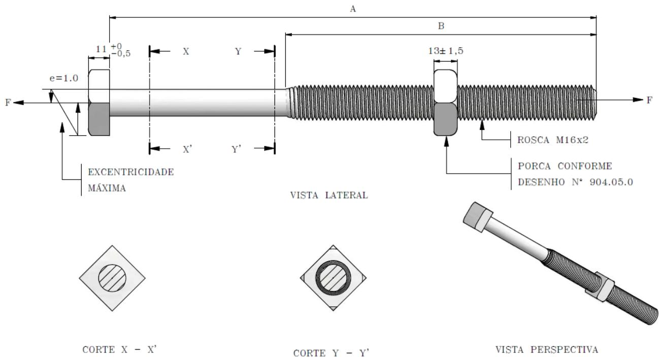
Figura 1 – Parafuso Cabeça Quadrada
